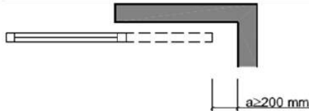
Figura 2.1 Holgura para evitar atrapamientos
