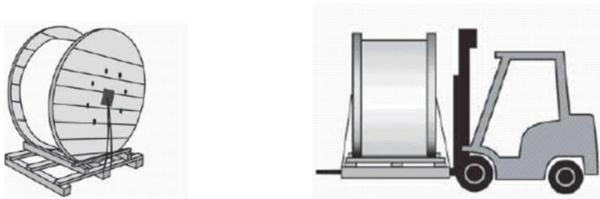
Figura 1 Transporte de la bobina
