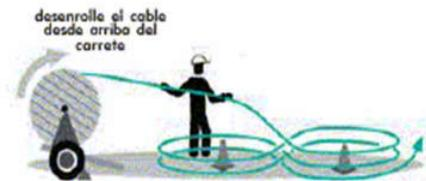
Figura 2 Desenrolle de la bobina
