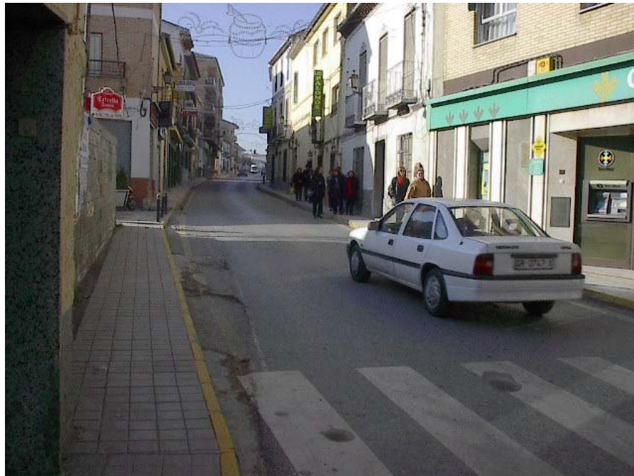
Foto 2 Ancho de aceras < 1,20m.
